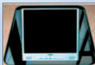
Platine fixée sous le plan de travail Ecran encastré sous le plan de travail et protégé par une vitre
